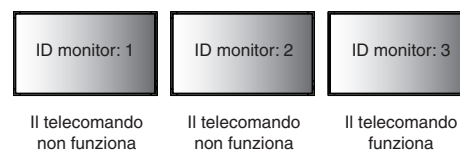
Figura 1 Telecomando nella modalità normale o con ID TELECOMANDO impostato su 0
